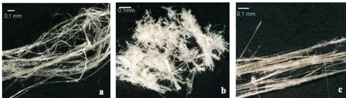
Rysunek 3. Długowłóknisty azbest chryzotylowy praktycznie nie zawierający zanieczyszczeń (a), chryzotylowy azbest krótkowłóknisty zanieczyszczony talkiem (b) i azbest amozytowy (c) [źródło: Bezpieczne postępowanie z azbestem i materiałami zawierającymi azbest].
