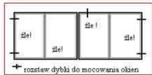
Rys. 3a Nieprawidłowe rozmieszczenie dybki mocujących do muru dwa zestawione wzajemnie okna dwudzielne. Jest to bardzo powszechna wada montażu. Okno nie ma mocowania w progu a w nadprożu jest tylko jeden łącznik.
